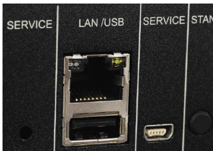
Dostęp do sieci zapewnimy albo przewodem LAN, albo przez Wi-Fi. Jedno z gniazd USB pozwala podłączyć nośniki pamięci z muzyką, drugie pełni funkcje serwisowe.
